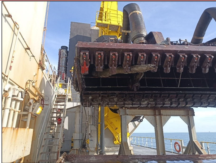
Figura 13. Particolare del palo in legno rimasto incastrato all'interno della testa aspirante.
